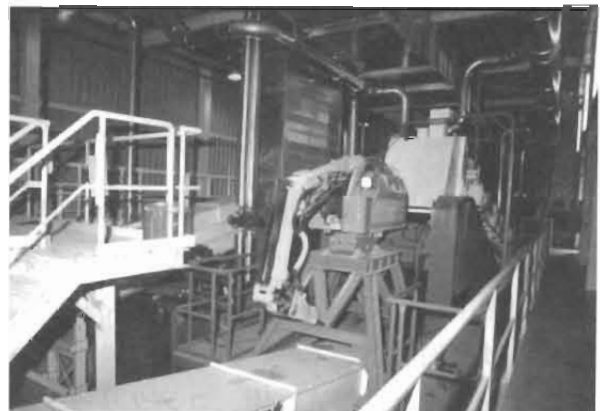
図2 コンクリート破碎装置とサンプル装置
